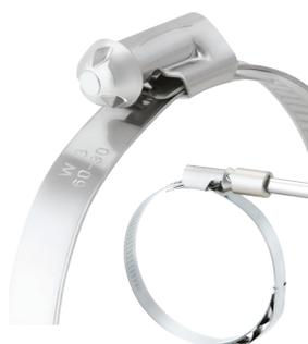
Die NORMACLAMP® TORRO® Manipulationssicherung kann nur mit einem Spezialwerkzeug montiert und demontiert werden. Der speziell entwickelte Schraubenkopf besitzt drei radiale Nuten, was bedeutet, dass keine handelsüblichen Werkzeuge verwendet werden können. Die automatisierte Montage mit einem Drehmomentschlüssel ist besonders effektiv, da die spezielle Form des Schraubenkopfes nur minimale Fehlausrichtung oder Versatz ermöglicht.
