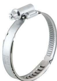
Die Radial® Federschelle besteht aus einer vernieteten Standardschelle mit einer Edelstahlmantelung. Dieser Einsatz in der Radial® wirkt als Feder. Der radial nach innen gerichtete Druck auf den Schlauch wird möglich, da das Material zwischen den Aussparungen und den Längsnähten wie Blattfedern wirkt.
