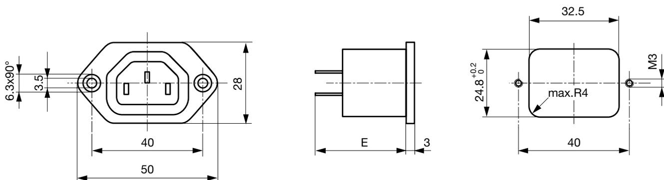
E: Lötanschlüsse: 24.1 mm
