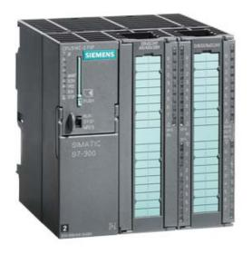
SIMATIC S7-300, CPU 314C-2 PTP KOMPAKT CPU MIT MPI, 24 DE/16 DA, 4AE, 2AA, 1 PT100, 4 SCHNELLE ZAEHLER (60 KHZ), INTEGRIERTE SCHNITTST. RS485, INTEGR.
