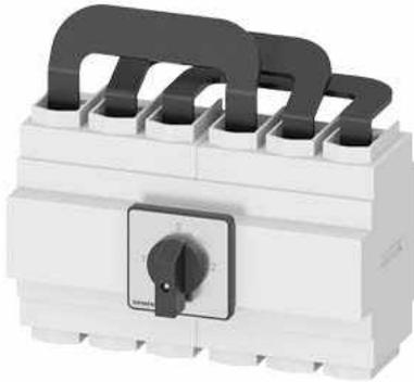
SENTRON, Lasttrennschalter 3LD, Umschalter, 3-polig, Iu: 160 A, Betriebsleistung / bei AC-23 A bei 400V: 75 kW, Frontbefestigt, Knebelantrieb, schwarz, 4-Loch Befestigung der Handhabe
