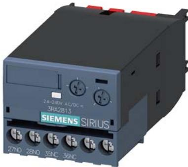
Elektronisch zeitverzögerter Hilfsschalter, ansprechverzögert, Relais 1 Ö + 1 S, Zeitbereich 0,05-100 s, AC/DC 24-240 V, 50/60 Hz, Varistor zur Bedämpfung der Schützspulen integriert, Schraubanschluss, frontseitig aufsnappbar auf Schütze 3RT2 und Hilfsschütze 3RH2
