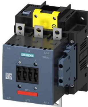
Leistungsschütz, AC-3e/AC-3 185 A, 90 kW / 400 V AC (50-60 Hz) / DC U<sub>c</sub>:96-127 V x (0,8-1,1) F-SPS Eingang 24 V DC 3-polig, Hilfskontakte 2 S + 2 Ö nicht lösbar
