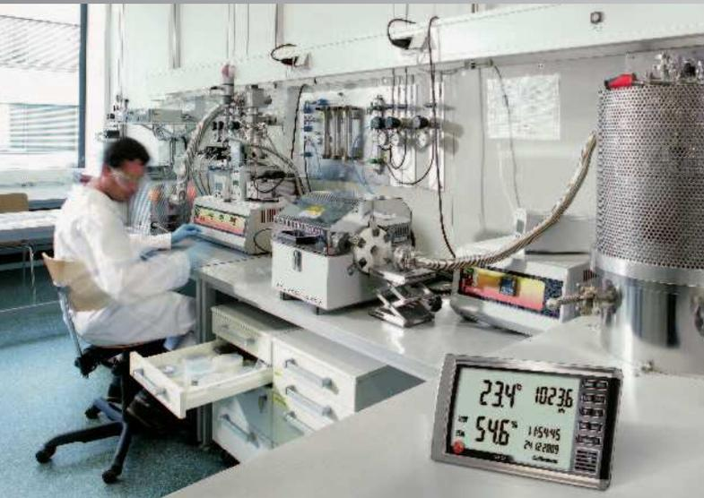
Ein Blick auf das testo 622 genügt: aktuelle Temperatur- und Feuchtwerte, sowie Datum und Uhrzeit können sofort abgelesen werden. Außerdem kann das Messgerät mit Hilfe der Kalibrier- und Abgleichsoftware sogar vor Ort kalibriert und abgeglichen werden – das spart Zeit und Kosten.
