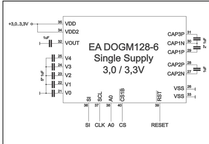
Zum Betrieb an +3,0V oder +3,3V (single supply) sind 9 externe Kondensatoren erforderlich.
