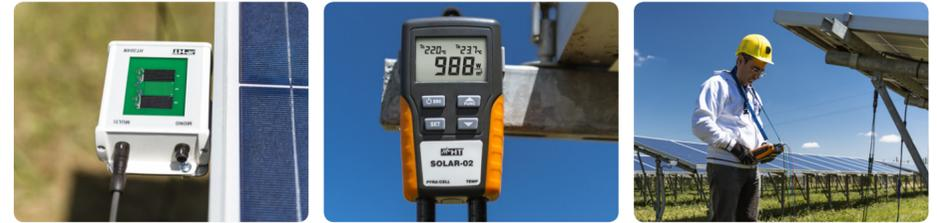
Einstrahlungssensor HT304N. Solar02 Datenlogger. Eine einzige Person kann die Messung durchführen.
