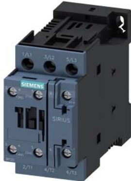
Leistungsschütz, AC-3 32 A, 15 kW / 400 V 1 S + 1 Ö, AC 50-60 Hz / DC
