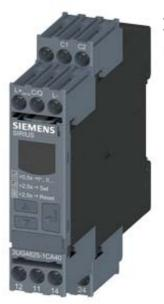
Digitales Überwachungsrelais zur Fehlerstromüberwachung mit Differenzstromwandler 3UL23 für IO-Link Einstellbereich 0,03 A bis 40 A getrennt für Warnschwelle und Abschaltwert Anlauf und Auslöseverzögerung 0 bis 999,9 s Abschalt-Hysterese bis 50% Warn-Hysterese 5% fest Breite 22,5mm, 2 Wechsler mit oder ohne Fehlerspeicher Schraubanschluss
