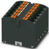
Verteilerblock, die Blöcke sind untereinander über den Leiterschacht brückbar, passende Steckbrücken siehe Zubehör, Grundklemme, Nennspannung: 450 V, Nennstrom: 24 A, Anschlussart: Push-in-Anschluss, Querschnitt: 0,14 mm<sup>2</sup> - 4 mm<sup>2</sup>, Montageart: aufrasten auf Tragschienenadapter, Direktmontage mit Flansch, Fliegend, Farbe: schwarz
