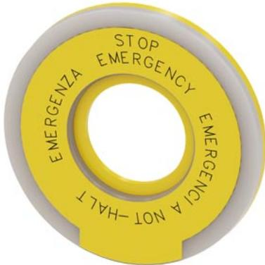
Unterlegscheibe rund für NOT-HALT-Pilzdrucktaster, gelb, beleuchtet, Stärke 5 mm, Außendurchmesser 60 mm, Innendurchmesser 23 mm, mit Beschriftung: NOT-HALT, 4-sprachig: DE,EN,IT,SP
