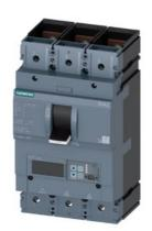
Leistungsschalter 3VA2 IEC Frame 630 Schaltvermögenklasse C lcu=110kA @ 415V 3-polig, Motorschutz ETU860M, LSIG, In=400A Überlastschutz Ir=160A...400A Kurzschlussschutz Isd=1,2..15x In, Ii=3..15x In Erdschlussschutz, abschaltbar Ig=0,2...1 x In, tg=0,05-0,8s Schraubenflachanschluss
