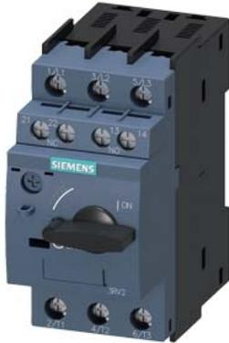
Leistungsschalter Baugröße S00 für den Motorschutz, CLASS 10 A-Auslöser 0,9...1,25 A N-Auslöser 16 A Schraubanschluss Standardschaltvermögen mit querliegenden Hilfsschalter 1S+1Ö
