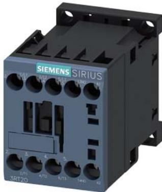
Leistungsschütz, AC-3 9 A, 4 kW / 400 V 1 S, AC 48 V, 50 / 60 Hz 3-polig,
