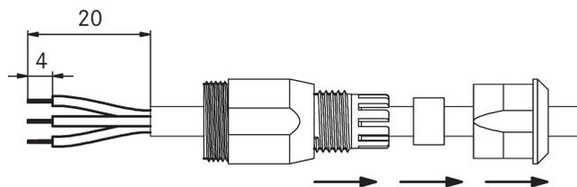
4. Führen Sie die Litzen nacheinander bis zum Anschlag in die vorgesehenen Kammern im Steckereinsatz ein und ziehen Sie die Schraube mit einem Innensechskantschlüssel 0,9 mm an. Das empfohlene Drehmoment ist 0,1 Nm.
