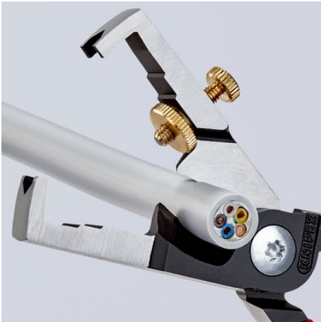
Filo de corte con rectificación de precisión, templado por inducción para un corte sin aplastamiento de cables de cobre y de aluminio de hasta \varnothing 15 mm ( 5 \times 2,5 \text{ mm}^2 )
