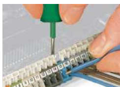
Leiter anschließen/lösen – Serie 256.
