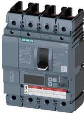
Leistungsschalter 3VA6 UL Frame 150 Schaltvermögenklasse M 35kA @ 480V 4-polig, Anlagenschutz ETU830, LIG, In=150A Überlastschutz, 100% rated Ir=60A...150A Kurzschlusschutz li=1,5...10 x In Erdschlusschutz Ig=0,2...1 x In, tg=0,05-0,8s ohne Anschluss
