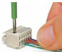
Leiter anschließen – mit Schraubendreher (2,5 x 0,4) mm. Betätigung rechtwinklig zur Leiteranschlussrichtung
