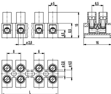
Die Buchsenklemmleiste 302 gehört zu unseren kleinsten Buchsenklemmleisten. Sie ist im Raster 8 mm von 1- bis 12-polig erhältlich und kann leicht in die gewünschte Polzahl geschnitten werden. Das biegsame Polyamidgehäuse ermöglicht die Befestigung auch auf gewölbten Oberflächen.
