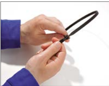
1. leg het smalle gedeelte van de bundelband in de open sluitkop.
