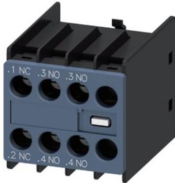
Hilfsschalter, frontseitig, 2 S + 1 Ö, .1/2, .3/4, .3/4, --/--, Strombahn: 1 Ö, 1 S, 1 S, --, Schraubanschluss, für Schütze 3RT2 und Hilfsschütze 3RH2
