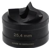
Blechlocher für runde Ausbrüche, Durchmesser Ausbruch: 25,4 mm, Maximale Wandstärke: 2,0 mm bei S 235 Blech, Material: Stahl
