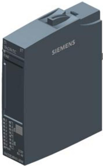
SIPLUS ET 200SP DI 16X24VDC ST TX RAIL -40...+70°C TX mit 85°C für 10min mit Conformal Coating based on 6ES7131-6BH01-0BA0 . Eingangstyp 3 (IEC 61131), Sink Input, (PNP, P-lesend), Verpackungseinheit: 1 Stück, passend für BU-Typ A0, Farbcode CC00, "Eingangsverzögerung 0,05..20ms Modul-Diagnose für: Drahtbruch, Versorgungsspannung
