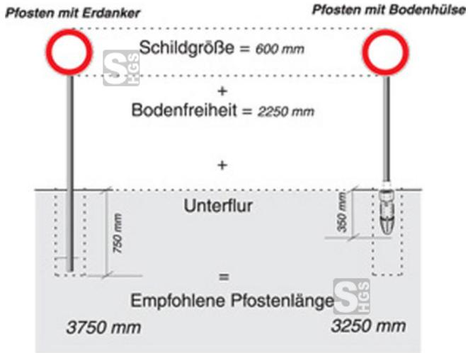
Technische Ansicht: Bestimmung der Pfostenlänge
