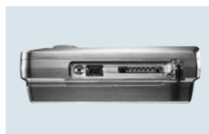
Seitlicher Anschluss von Mini-USB-Kabel und SD-Karte
