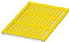
Leitermarker, Matte, gelb, unbeschriftet, beschriftbar mit: TOPMARK NEO, TOPMARK LASER, BLUEMARK ID COLOR, BLUEMARK ID, BLUEMARK CLED, THERMOMARK PRIME, THERMOMARK CARD 2.0, THERMOMARK CARD, Montageart: einschieben, Kabeldurchmesserbereich: 1,5 ... 14 mm, Schriftfeldgröße: 30 x 4 mm, Anzahl der Einzelschilder: 30
