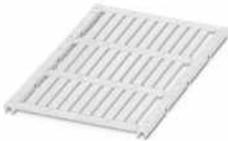
Leitermarker, Matte, weiß, unbeschriftet, beschriftbar mit: TOPMARK NEO, TOPMARK LASER, BLUEMARK ID COLOR, BLUEMARK ID, BLUEMARK CLED, THERMOMARK PRIME, THERMOMARK CARD 2.0, THERMOMARK CARD, Montageart: einschieben, Kabeldurchmesserbereich: 1,5 ... 14 mm, Schriftfeldgröße: 30 x 4 mm, Anzahl der Einzelschilder: 30
