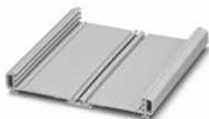
Strangprofilgehäuse, Verrastung mit Seitenelementen, Verrastung mit Fußelement, Grundprofil, Farbe: lichtgrau (7035), Profillänge (konfigurierbar): 3 cm ... 200 cm, Tiefe: 19,8 mm, Hinweis: benötigte Profillänge = Leiterplattenlänge - 16,2 mm
