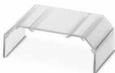
Strangprofilgehäuse, Verrastung, Abdeckung, Farbe: transparent, Breite: 92 mm, Profillänge (konfigurierbar): 3 cm ... 100 cm, Höhe: 34 mm, Hinweis: max. Länge der Abdeckung = Leiterplattenlänge - 19 mm
