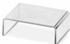
Strangprofilgehäuse, Verrastung, Abdeckung, Farbe: transparent, Breite: 73 mm, Profillänge (konfigurierbar): 3 cm ... 100 cm, Höhe: 24 mm, Hinweis: max. Länge der Abdeckung = Leiterplattenlänge - 19 mm
