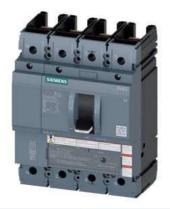
Leistungsschalter 3VA5 UL Frame 250 Schaltvermögenklasse M 35kA @ 480 V 4-polig, Anlagenschutz TM230, FTAM, In=125A Überlastschutz, 100%-rated Ir=125A fest eingestellt Kurzschlussschutz Ii=5...10 x In N-Leiterschutz 1 ohne Anschluss
