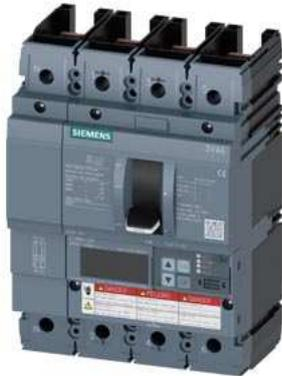
Leistungsschalter 3VA6 UL Frame 250 Schaltvermögenklasse C 100kA @ 480V 4-polig, Anlagenschutz ETU860, LSIG, In=100A Überlastschutz Ir=40A...100A Kurzschlusschutz I<sub>sd</sub>=0,6..10x In, I<sub>i</sub>=1,5..12x In N-Leiterschutz einstellbar (OFF, bis 160%) Erdschlusschutz I<sub>g</sub>=0,2...1 x In= tg=0,05-0,8s ohne Anschluss
