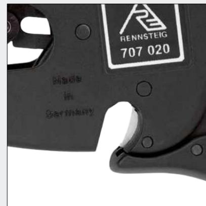
Ergonomische Griffe mit Schutzfunktion für Kabelschneider bis 10 mm<sup>2</sup>
