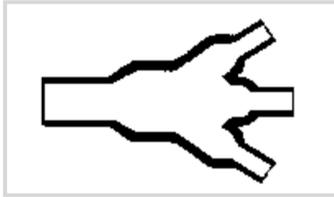
Form des Formteils: **Y-Form**Anzahl der Abzweigungen/Finger: **4**Materialcode: **25**Materialsystemcode: **25**Vorbeschichtung mit Klebemittel: **Ja**
