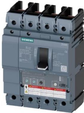
Leistungsschalter 3VA6 UL Frame 150 Schaltvermögenklasse L 150kA @ 480V 4-polig, Anlagenschutz ETU320, LI, In=150A Überlastschutz Ir=60A...150A Kurzschlusschutz Ii=1,5...10 x In N-Leiterschutz einstellbar (OFF, 50%, 100%) ohne Anschluss
