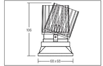
LED-System-Einbaustrahler COUPLED, vertieft , weiß. Ausgeführt in kompakter Bauform für werkzeuglose Schnellmontage zum Deckeneinbau. Montage nur zzgl. Einputz- oder Einbaurahmen
