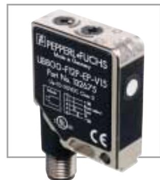
Ultraschall-Sensoren von Pepperl+Fuchs arbeiten mit einer Piezokeramik als Schallsender und -empfänger. Zur Auskoppelung des Ultraschalls an das akustisch dünnere Medium Luft dient eine patentierte Auskoppelschicht aus speziellem Material.
