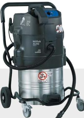
Sicherheitssauger Typ S 960 mit 3,5 m Saugschlauch Ø 27 mm, Saugrohrhalter, Filtersack und -element, Werkzeugadapter, Kabelaufwicklung mit 7,5 m Netzkabel.
