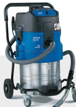
Sicherheitssauger Typ S 560-Asbest mit 3-m-Saugschlauch (Ø 36 mm), gebogenem Edelstahl-Handrohr, Filtersack und -element, Schrägröhrdüse und Gerätesteckdose.
