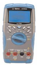
Darüber hinaus können Sie Ihr Hand-Digitalmultimeter mithilfe der mitgelieferten PC-Software Agilent Graphical User Interface (GUI) schnell und einfach als Datenlogger konfigurieren. Für die Analyse der erfassten Messdaten stehen komfortable mathematische Funktionen zur Verfügung. Das U1252A enthält außerdem einen programmierbaren Rechteckgenerator, der als Stimulussignalquelle für die Fehlersuche verwendet werden kann.
