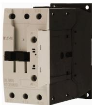
Leistungsschütz, 3-polig, 380 V 400 V 30 kW, 230 V 50 Hz, 240 V 60 Hz, Wechselstrombetätigung, Schraubklemmen
