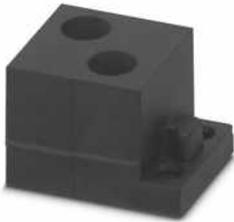
Kabeltülle, klein, Anzahl der Leitungen: 2, Ausführung: Rundkabel, geschlitzt, Leitungsaußendurchmesser: 2x 7 mm ... 8 mm, Material: NBR, Farbe: schwarz, Länge: 29,5 mm, Breite: 19,5 mm, Höhe: 17 mm
