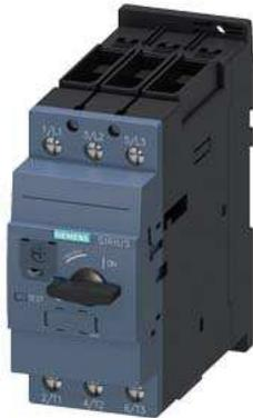
Leistungsschalter Baugröße S2 für den Trafoschutz A-Auslöser 28...36 A N-Auslöser 820 A Schraubanschluss Standardschaltvermögen
