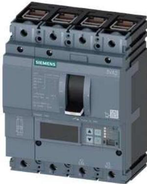
Leistungsschalter 3VA2 IEC Frame 160 Schaltvermögenklasse H Icu=85kA @ 415V 4-polig, Anlagenschutz ETU860, LSIG, In=63A Überlastschutz Ir=25A...63A Kurzschlusschutz Isd=0,6..10x In, li=1,5..12x In N-Leiterschutz einstellbar (OFF, bis 160%) Erdschlusschutz, abschaltbar Ig=0,25...1 x In= tg=0,05-0,8s Klemmenanschluss
