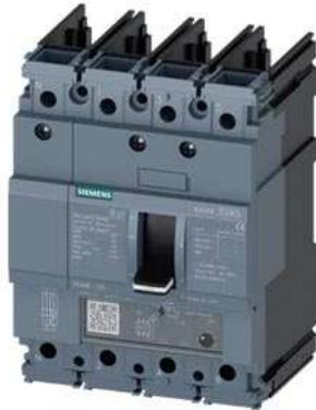
Leistungsschalter 3VA5 UL Frame 125 Schaltvermögenklasse H 65kA @ 480V 4-polig, Anlagenschutz TM240, ATAM, In=60A Überlastschutz Ir=48A...60A Kurzschlusschutz Ii=5...10 x In N-Leiter ungeschützt ohne Anschluss
