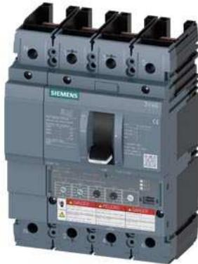
Leistungsschalter 3VA6 UL Frame 150 Schaltvermögenklasse C 100kA @ 480V 4-polig, Anlagenschutz ETU350, LSI, In=40A Überlastschutz Ir=16A...40A Kurzschlusschutz I<sub>sd</sub>=1,5...10 x Ir, I<sub>i</sub>=12 x In N-Leiterschutz einstellbar (OFF, 100%) ohne Anschluss
