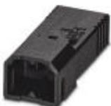
Leiterplattenstecker, Nennstrom: 6 A, Bemessungsspannung (III/2): 160 V, Nennquerschnitt: 0,75 mm<sup>2</sup>, Polzahl: 5, Rastermaß: 2,5 mm, Anschlussart: Crimpanschluss, Farbe: schwarz, Kontaktoberfläche: Zinn
