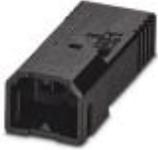
Leiterplattenstecker, Nennstrom: 6 A, Bemessungsspannung (III/2): 160 V, Nennquerschnitt: 0,75 mm<sup>2</sup>, Polzahl: 7, Rastermaß: 2,5 mm, Anschlussart: Crimpanschluss, Farbe: schwarz, Kontaktoberfläche: Zinn
