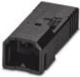
Leiterplattenstecker, Nennstrom: 6 A, Bemessungsspannung (III/2): 160 V, Nennquerschnitt: 0,75 mm<sup>2</sup>, Polzahl: 2, Rastermaß: 2,5 mm, Anschlussart: Crimpanschluss, Farbe: schwarz, Kontaktoberfläche: Zinn
