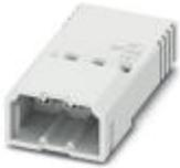
Leiterplattenstecker, Nennstrom: 6 A, Bemessungsspannung (III/2): 160 V, Nennquerschnitt: 0,75 mm<sup>2</sup>, Polzahl: 4, Rastermaß: 2,5 mm, Anschlussart: Crimpanschluss, Farbe: weiß, Kontaktoberfläche: Zinn
