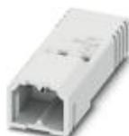
Leiterplattenstecker, Nennstrom: 6 A, Bemessungsspannung (III/2): 160 V, Nennquerschnitt: 0,75 mm<sup>2</sup>, Polzahl: 2, Rastermaß: 2,5 mm, Anschlussart: Crimpanschluss, Farbe: weiß, Kontaktfläche: Zinn
