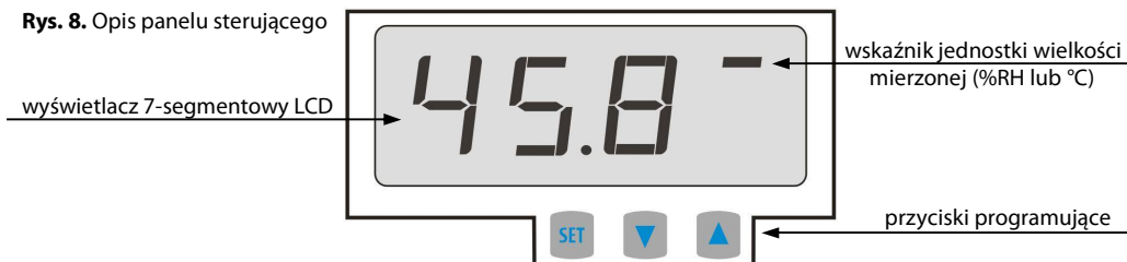
Rys. 8. Opis panelu sterującego
