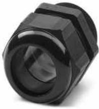
Kabelverschraubung, Material Verschraubung: PA, Kabelaußendurchmesser 30 mm ... 38 mm, Schirmung: nein, Anschlussgewinde: Pg42, Farbe: tiefschwarz RAL 9005
