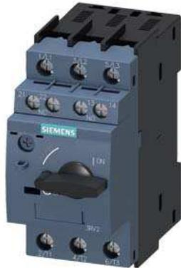
Leistungsschalter Baugröße S0 für den Trafoschutz A-Auslöser 16...22 A N-Auslöser 364 A Schraubanschluss Standardschaltvermögen mit querliegenden Hilfsschalter 1S+1Ö
