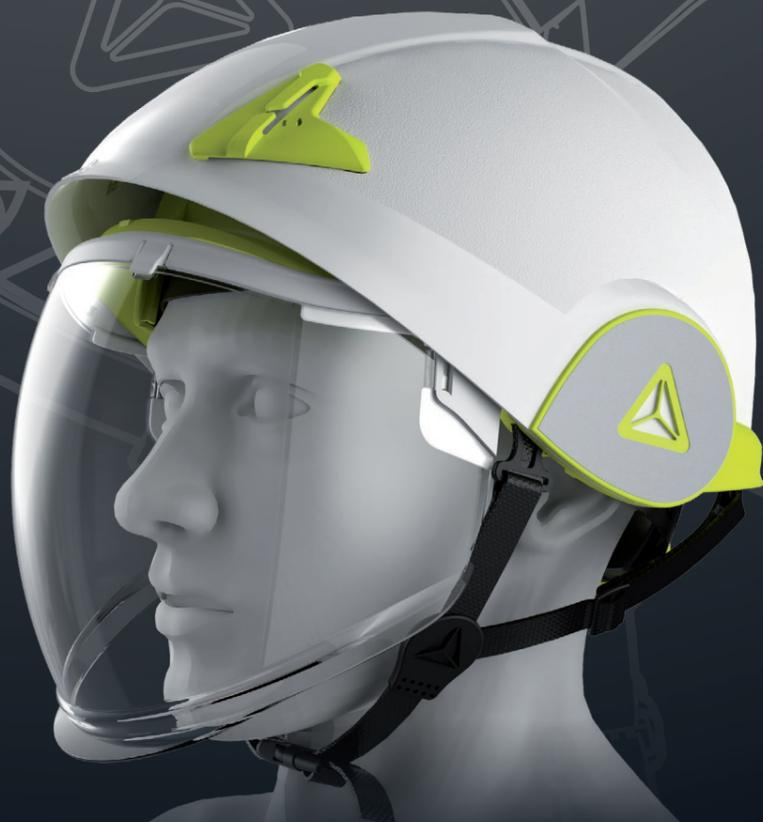
Casco de seguridad equipado con una **visera integrada** certificada conforme a la norma **GS-ET-29 Clase 1** (arco eléctrico), una **capucha textil en 6 puntos** y un sistema de ajuste **ROTOR**, intuitivo y fácil de usar.
